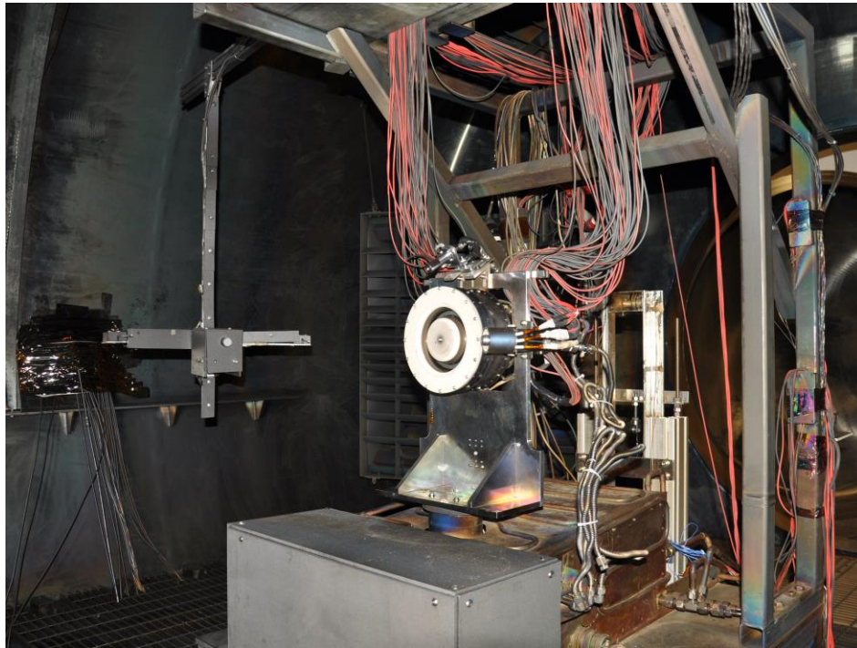
Figure 4.2: IHD2000-EM11 HET installed in VTF-2.
